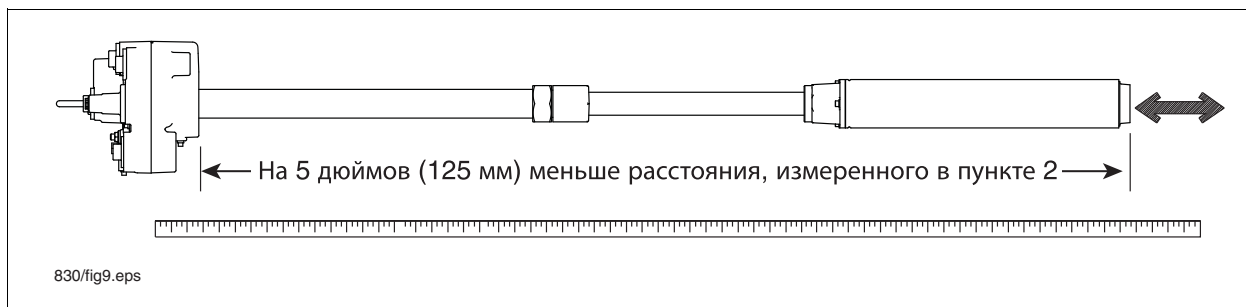
Рис. 10. Регулировка длины насоса
