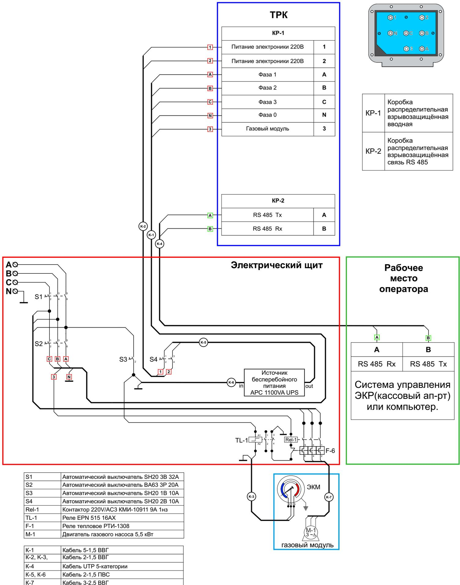
Электрическая схема подключения топливораздаточных колонок с напорной гидравликой
