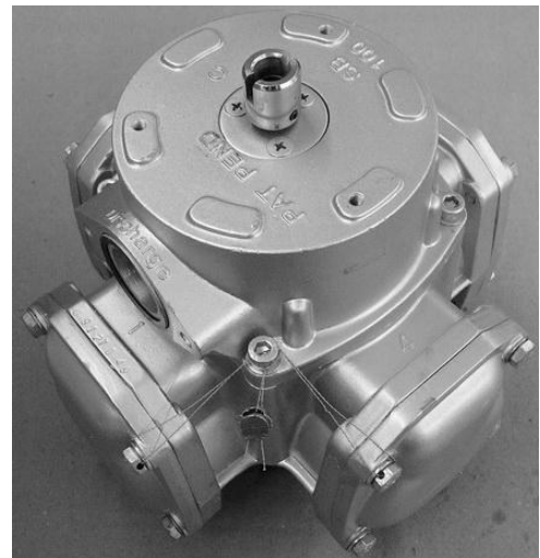
Рисунок В.3 Пломбировка измерителя объема
