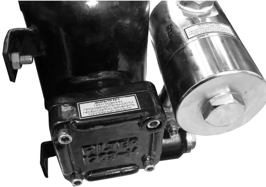
*Рисунок 8 — Расположение фильтров на сепараторе*
